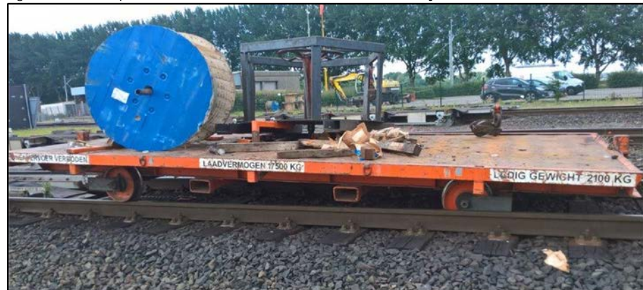
Figuur 2. De ontspoorde lorrie met materialen die betrokken is bij het incident
